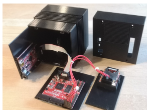
Ordinateur RISC-V sur FPGA iCE40HX8K-EVB tournant sous UNIX xv6
